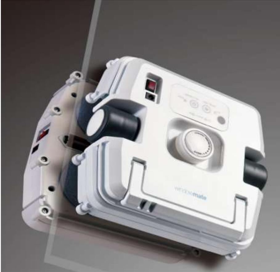
クリーニング装置とナビゲーション装置の2つの機械で窓ガラスを挟み掃除をするロボットです。ボタンを押すだけで自動で窓を掃除を行い、掃除が終わるとセットした位置に戻ります。その為、高所の窓や身を乗り出すと危険な場所、人が入れない隙間の窓掃除にとっても便利です。
