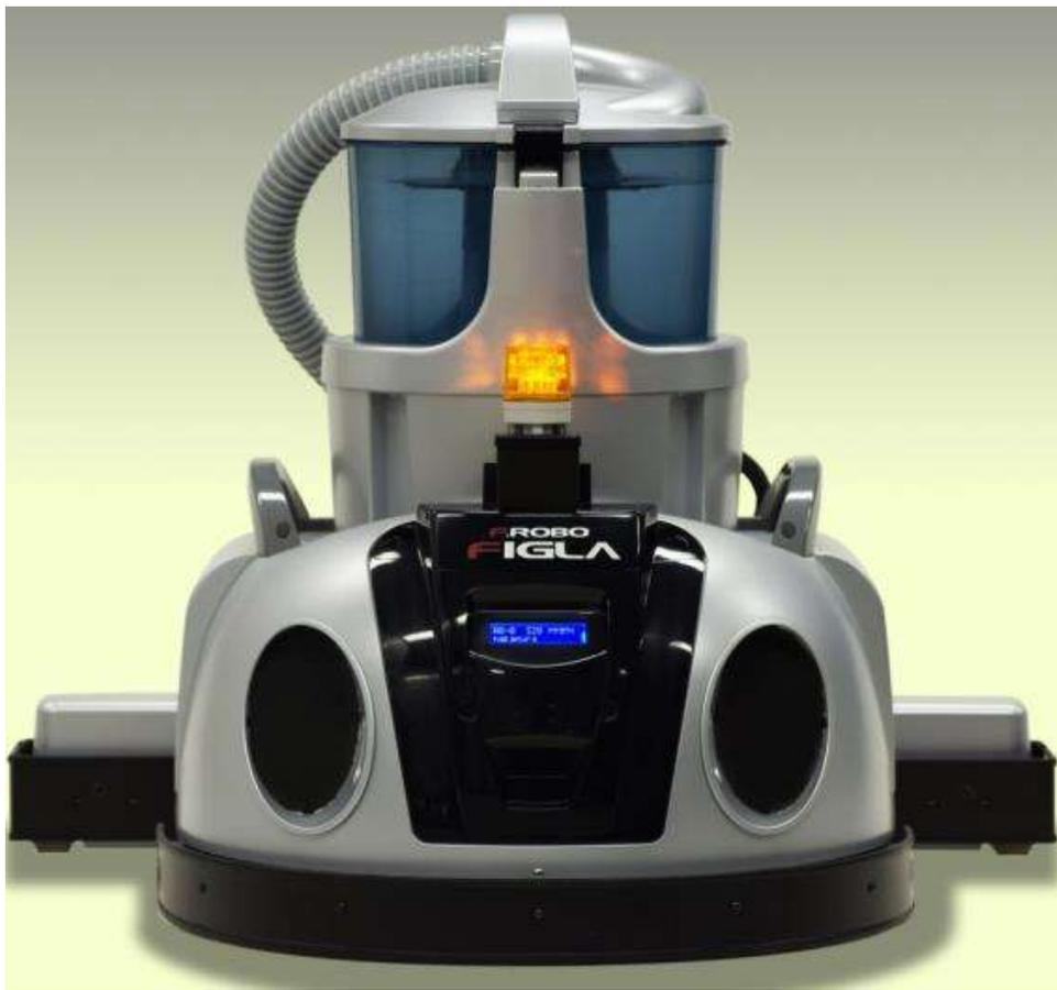
自律走行型清掃ロボット『エフロボ・クリーン』は建物に付帯設備を増設する事無く、各種センサーで壁との距離を測りながら、予めプログラミングしたルートを自律走行し、ムダ・ムラ無く一定の清掃品質を保ち、人とロボットの作業の適正化を行います。内蔵センサーで未然に衝突を防止し、万が一接触してもバンパーセンサーで衝撃を大幅に軽減致します。音声機能により注意喚起も可能です。
