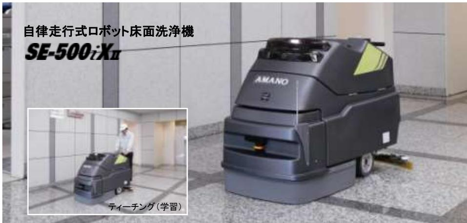
【SE-500iXⅡ】パソコンなどによる複雑なプログラム入力は不要。作業者の操作を記憶して同じ作業を自動運転で再現します。
