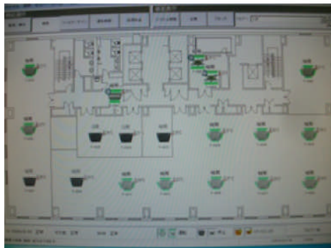
全熱交換器(一次外気処理?)が竣工図、設備実態と違っている
