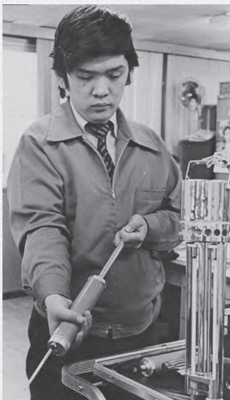
一酸化炭素、炭酸ガス検知のため、計器に空気を採取する
